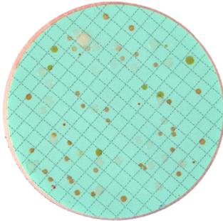
Probe aus Oberflächengewässer nach 36 Stunden bei 30 °C
